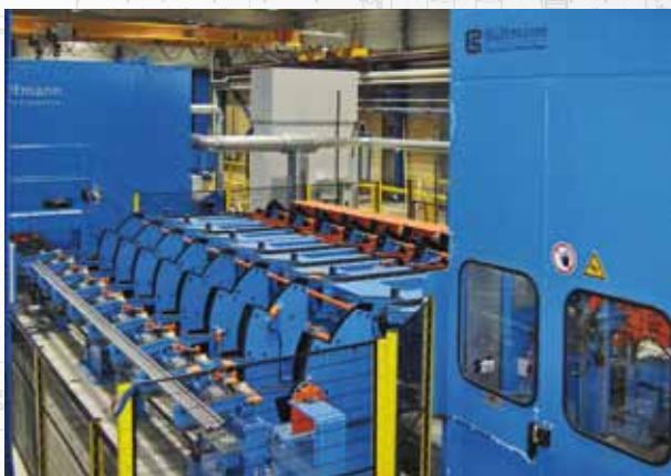
Handling zwischen Schäl- und Richtmaschine Handling between peeling and straightening machine
